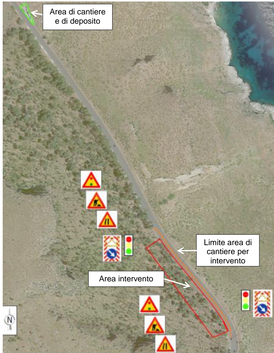
Figura 6-3: Posizione delle aree di cantiere.
