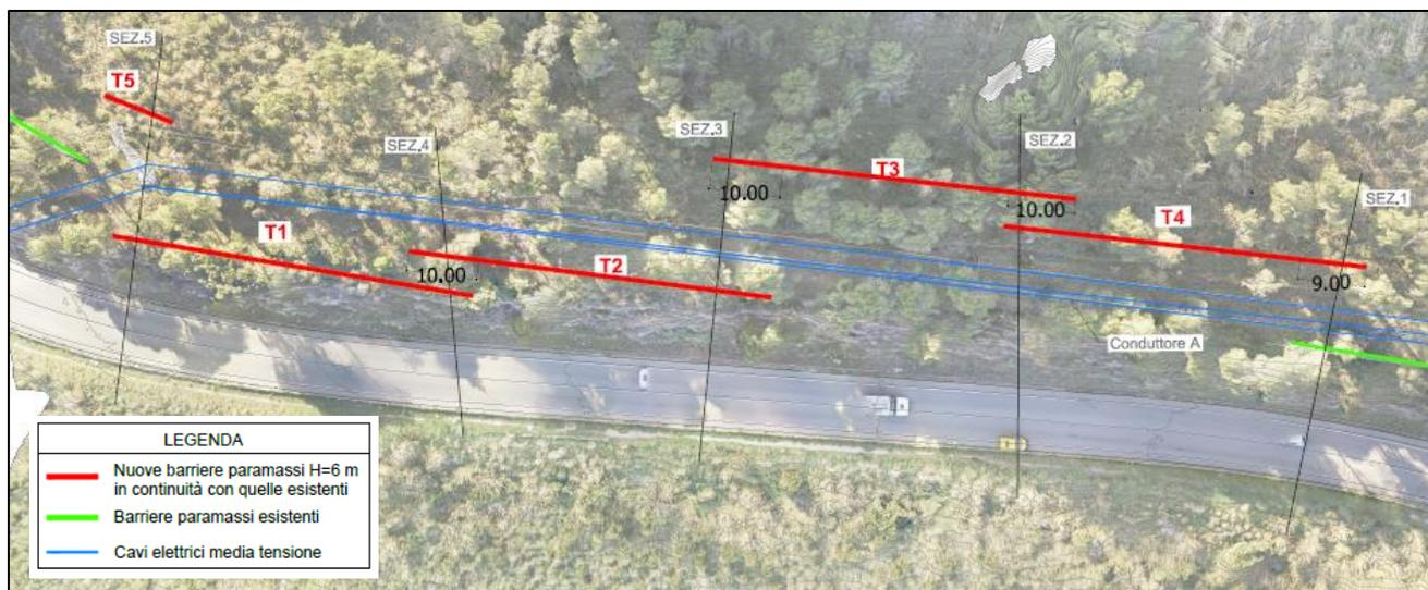
Figura 6-1 – Ortofoto con indicazione dell’area di progetto e della posizione delle barriere.
